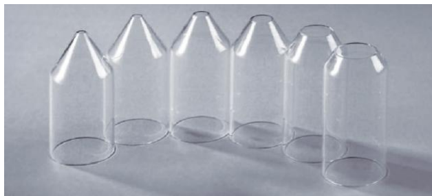
図7 粉体の流動性を測定するためのガラス製漏斗のセット。 左からフローグレード1〜7(模範結果 図2および3を参照)
