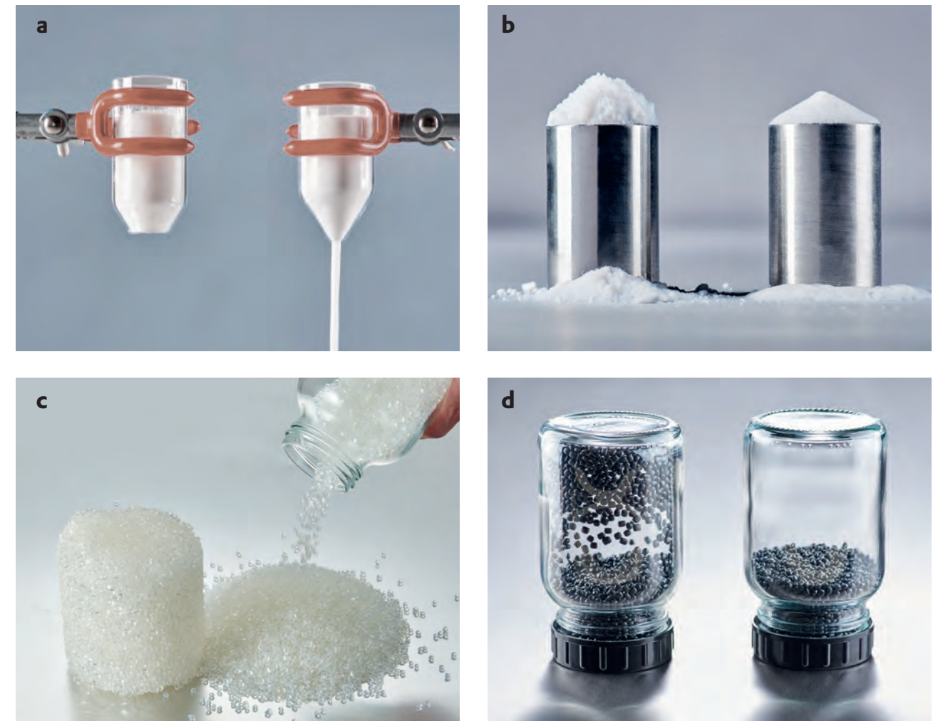
図 7a ~ d 粉末の流動性改善：a) 粉末がファンネルを流れる。b) 粉末の安息角が低い。c) 粉末の固結が防止される。d) 非導電性粉末に対する帯電防止効果が改善される。ここに示される粉末は効果を説明するための参考用粉末であり、実際の 3D プリンティング用の粉末ではありません。
