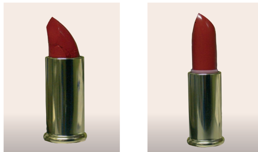
図5 AEROSIL®を添加した口紅の熱安定性。口紅の組成は同一。 左: 50°Cで24時間保存した後の口紅 右: AEROSIL® 200を4 wt%添加した口紅
