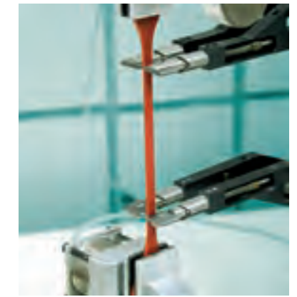
シリコーンシーラント材の機械特性試験
