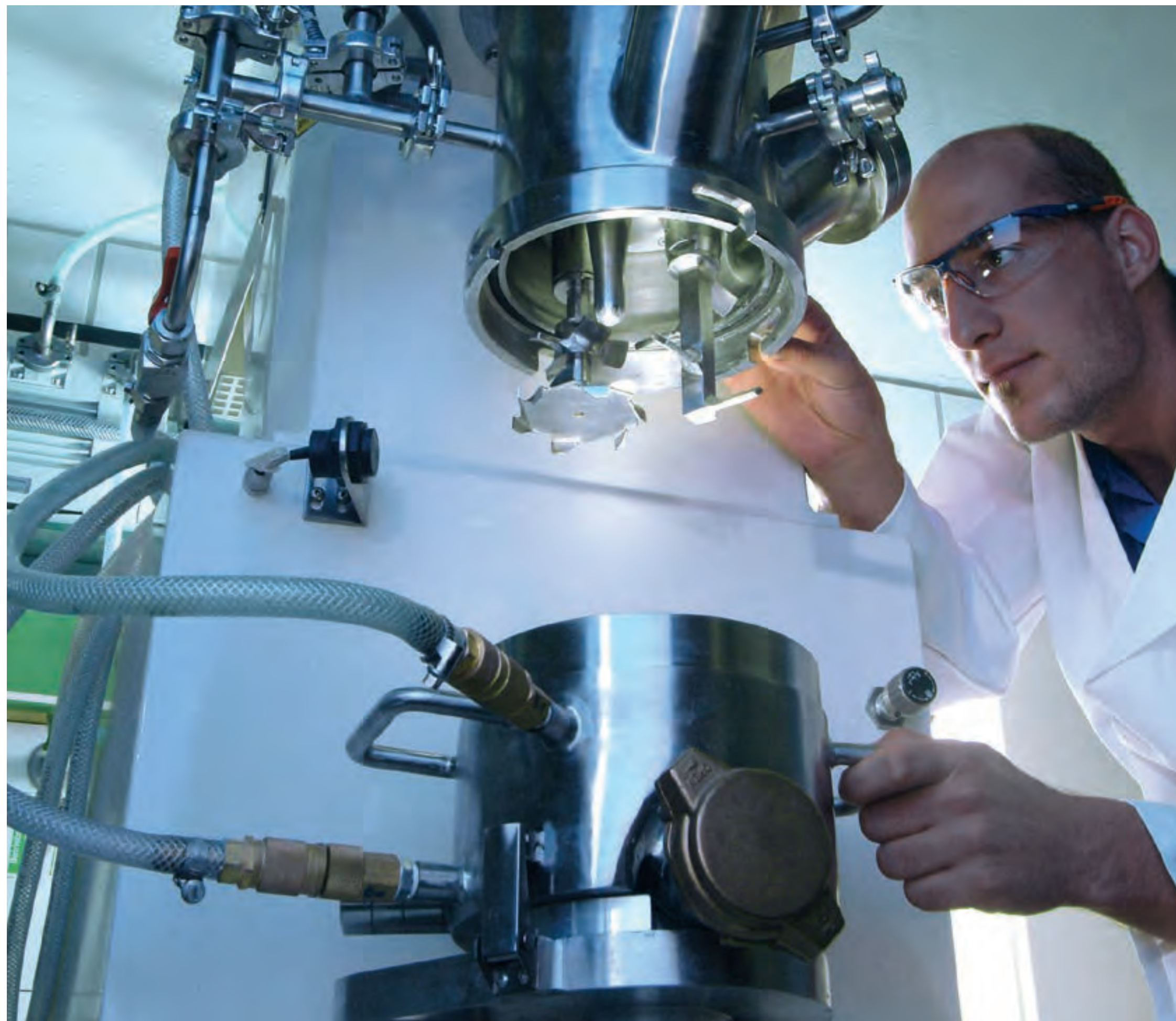
接着剤・シーラント生産用のプラネタリミキサー （Hermann Linden社製（ドイツ・マリーエンハイデ））
