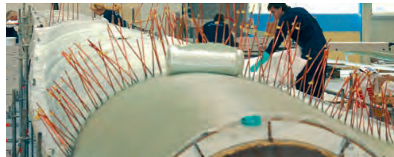
風力発電機のローターブレードの製造工程（Nordex AG社製（ドイツ・ノルダーシュテット））
